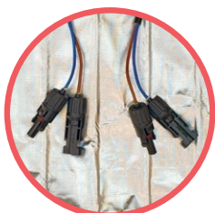
Cavi di alimentazione e connettori MC4
