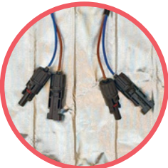
Cavi di alimentazione e connettori MC4
